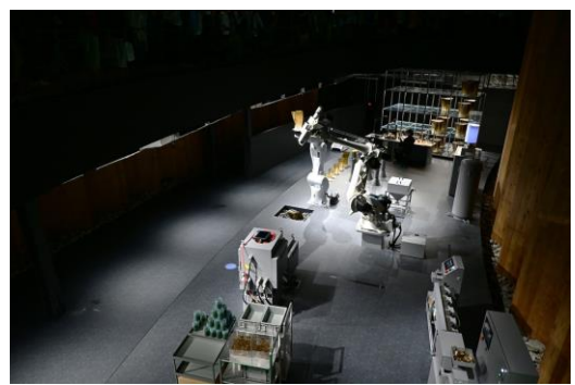
此區展示由混合藻類的生物塑膠3D列印的椅子製作過程
