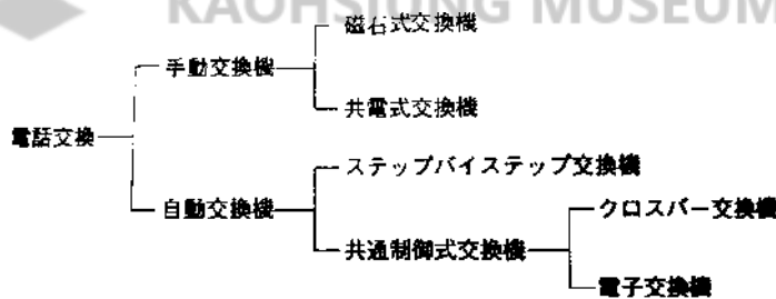
圖 1 電話交換機的分類
