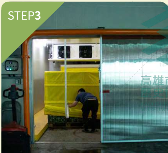
預冷 壓差預冷機可在短時間內，將蔬菜中心溫度降至 3-5 度，使蔬菜蒸散速度放慢而暫時休眠，延緩蔬菜老化時間。蔡孟珊攝
