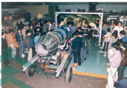
1980 年代因應空軍國防需求，研發高性能攔截 IDF 經國號戰機。研製過程中發動機試裝情形。
