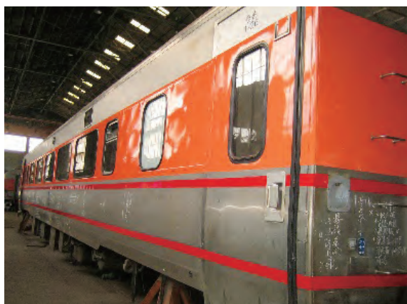
圖 10 自強號客車車壁油麗光漆
