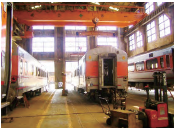
圖 11 自強號客車原鋼索式吊具 圖片來源：張簡慶豐提供。
