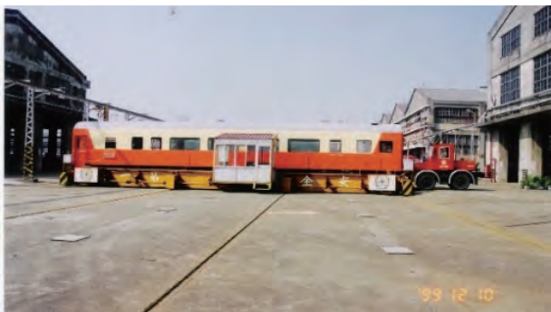
圖 6 公路輪胎型調車機調車作業 圖片來源：張簡慶豐提供。
