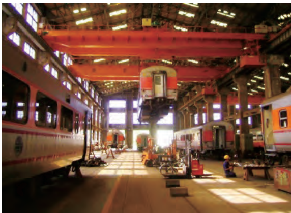
圖 12 自強號客車鋼索式吊具吊掛車輛 圖片來源：張簡慶豐提供。
