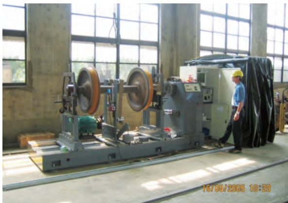
圖 7 新購車輪動平衡校正機
