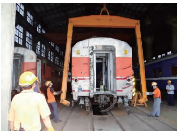
圖 13 自強號客車用鋼構式吊具 圖片來源：張簡慶豐提供。
