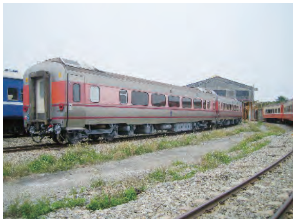
圖 8 自強號客車車壁貼紙褪色修補
