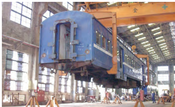
圖 6 普通客車三檢進入修車定位之過程 圖片來源：張簡坤國提供。
