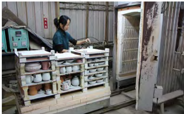
同一窯內不同作品的擺放位置，也會對瓷器品質造成影響。如何在相應位置擺放更合適的作品，全靠師傅的經驗。提供 / 采青窯
