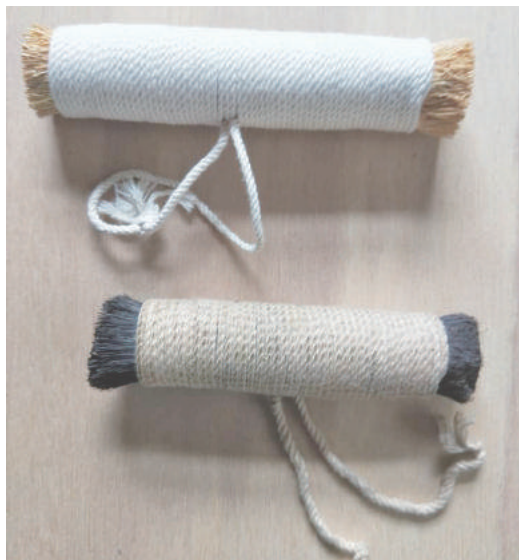
圖 31 網代工具（處理木片表面） 圖片來源：陳啓仁提供。
