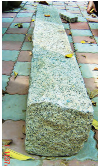
照片 14 花崗岩的石材 說明：石材短面平整，長面較不平整
