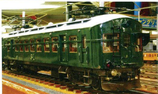
スケールは1/32、ゲージサイズは45mm。1933年に製作された著者オリジナルデザインの電車 その後1938年、1995年に動力と台車が改造された デザインの特徴は、側面の窓の手スリが車体外部にハンダ付けされている点と、自動連結器とバッファが併用されている点である
